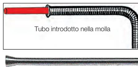
**Tipo per uso interno** (introduzione della molla nel tubo)
